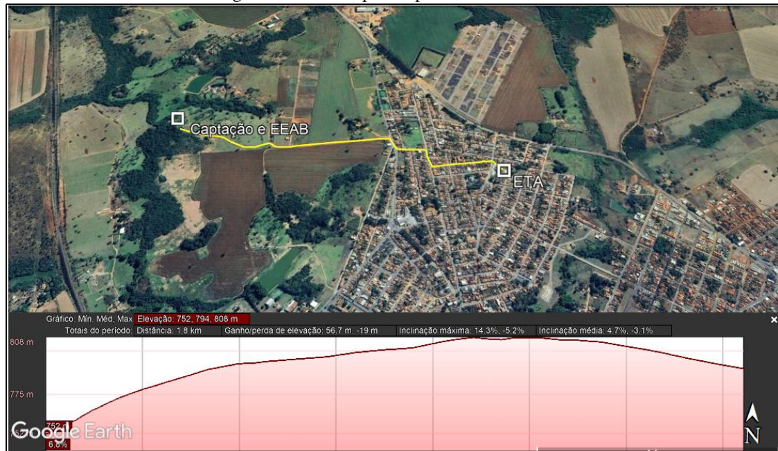
Figura 18: Planta e perfil aproximados da AAB
