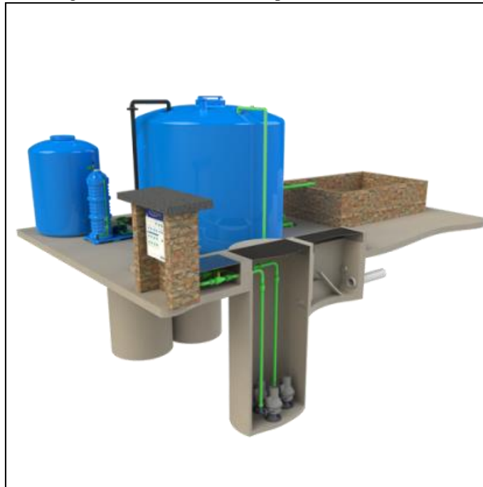
Figura 58: ETE modular – capacidade de 80 m 3 /dia
